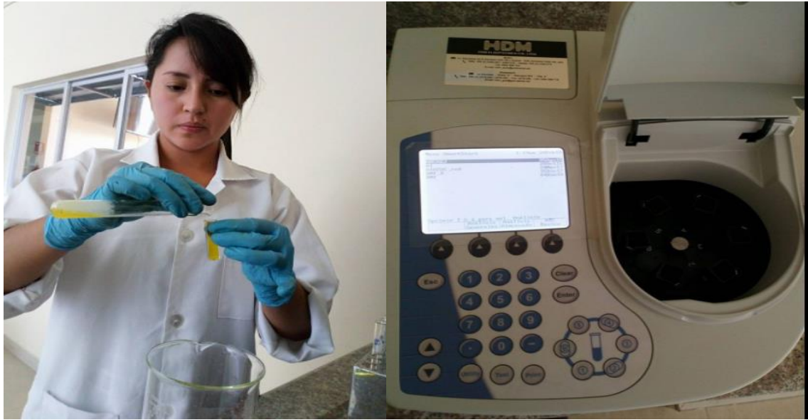
h) Lectura de las absorbancias de las soluciones en el espectrofotómetro.
