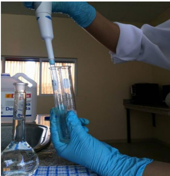
b) Colocación de 0,5 mL de solución patrón en tubo de ensayo.
