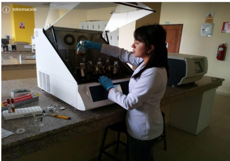
b) Colocación de los erlenmeyers con las soluciones a hidrolizar en el Shaker para su incubación a 37 °C y 150 rpm durante 24, 48 y 72 h
