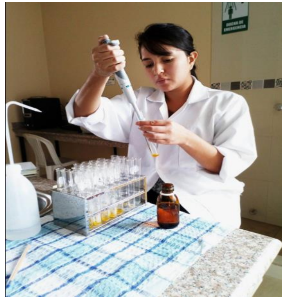
c) Colocación de 0,5 mL de solución DNS en tubo de ensayo.
