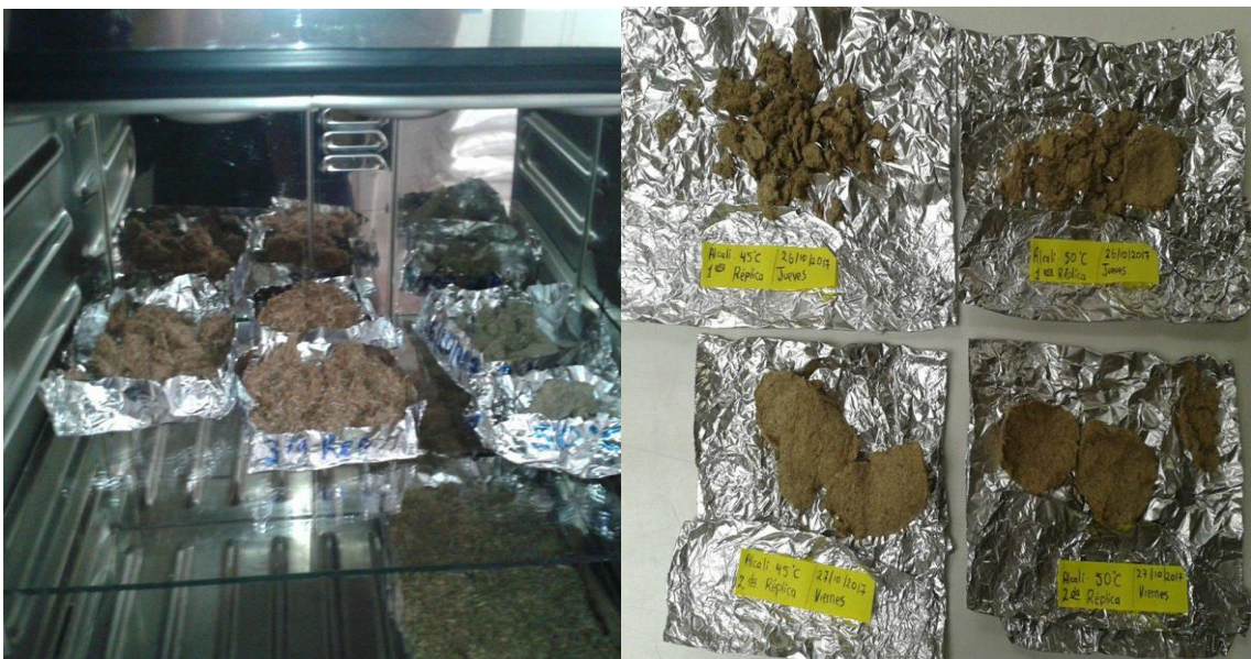
b) Secado del sustrato en estufa a 45 °C, 50 °C, 55 °C y 60 °C
