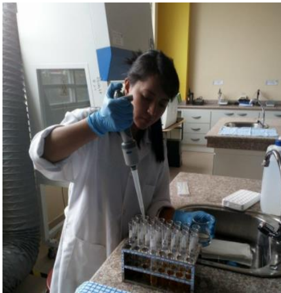
f) Aforamiento de los tubos de ensayo con 5 mL de agua destilada.
