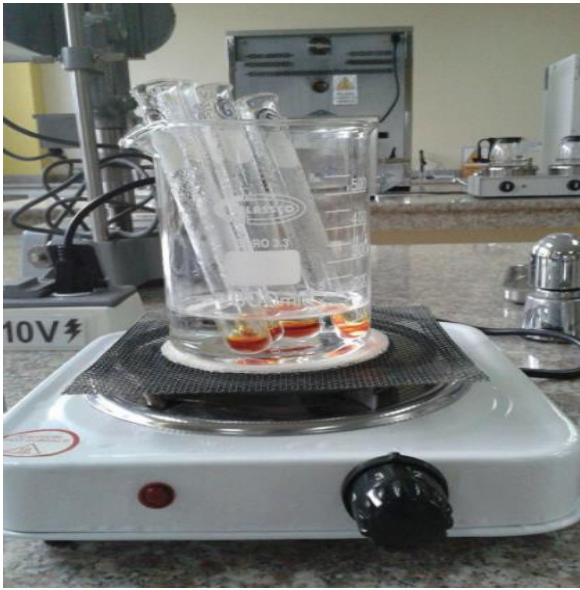
d) Tubos de ensayo sometidos a Baño María por 5 minutos.
