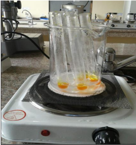
d) Tubos de ensayo sometidos a Baño María por 5 minutos.
