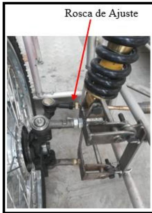
**Figura 17-4:** Ajuste del brazo de la dirección
