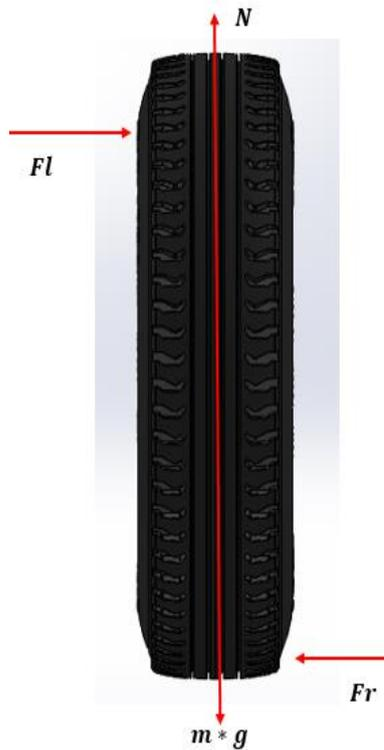
**Figura 5-3:** Diagrama del cuerpo libre del neumático
