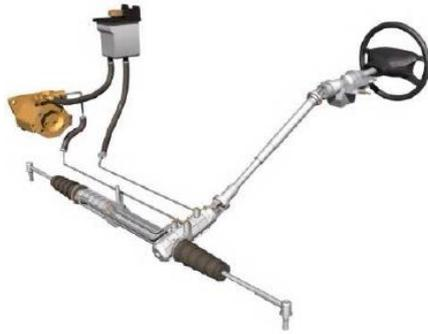
**Figura 9-2:** Direcciones de asistencia hidráulica
