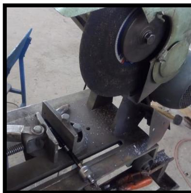
**Figura 5-4:** Corte del Brazo de dirección
