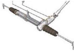
**Figura 16-2:** Piñón y cremallera del sistema de dirección
