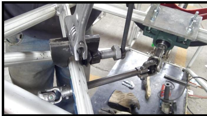
**Figura 9-4:** Implementación de la columna de dirección
