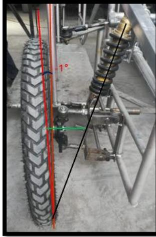
**Figura 15-4:** Ajuste del camber
