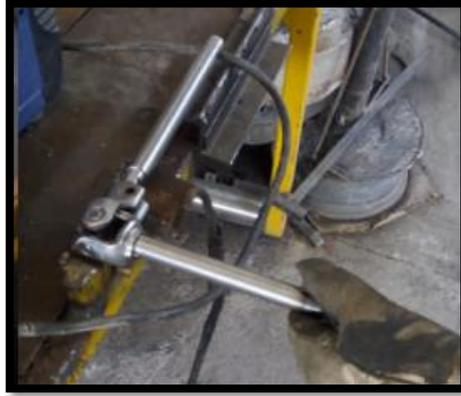
**Figura 8-4:** Implementación de la Columna de dirección
