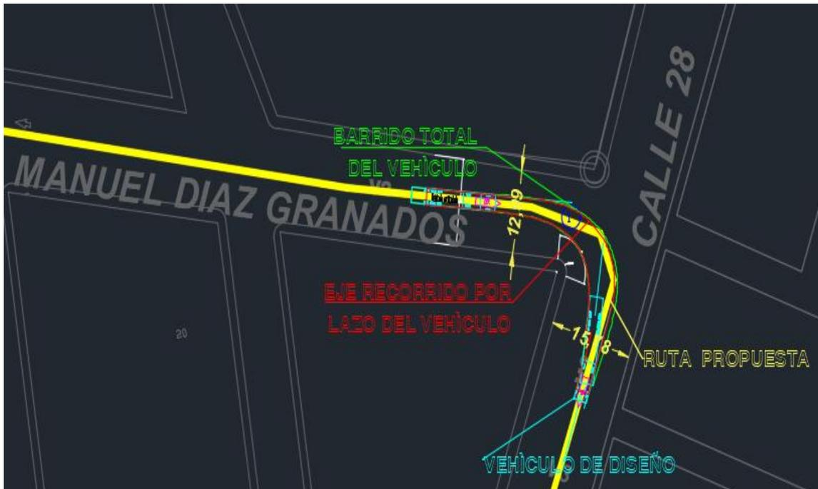
**Ilustración N°. 46: Simulación de barrido total de un vehículo de carga pesada de diseño en la intersección calle 28 y Manuel Díaz Granados**
