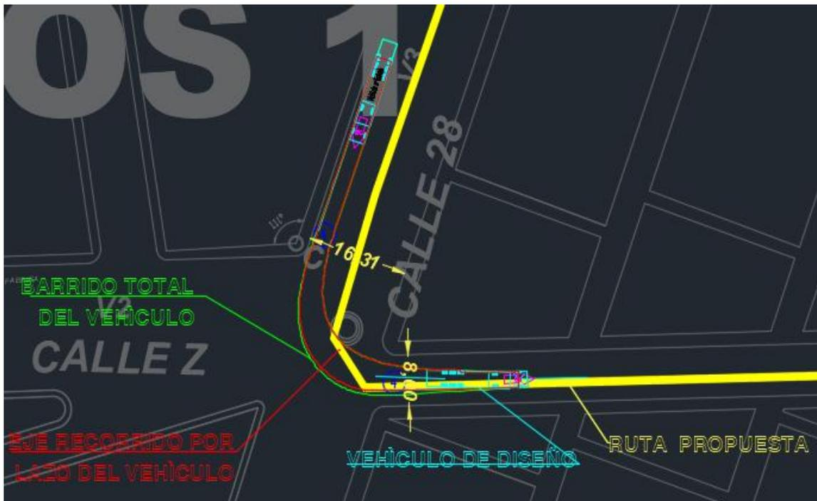
**Ilustración 45: Simulación de barrido total del vehículo de diseño en la intersección calle z y calle 28**
