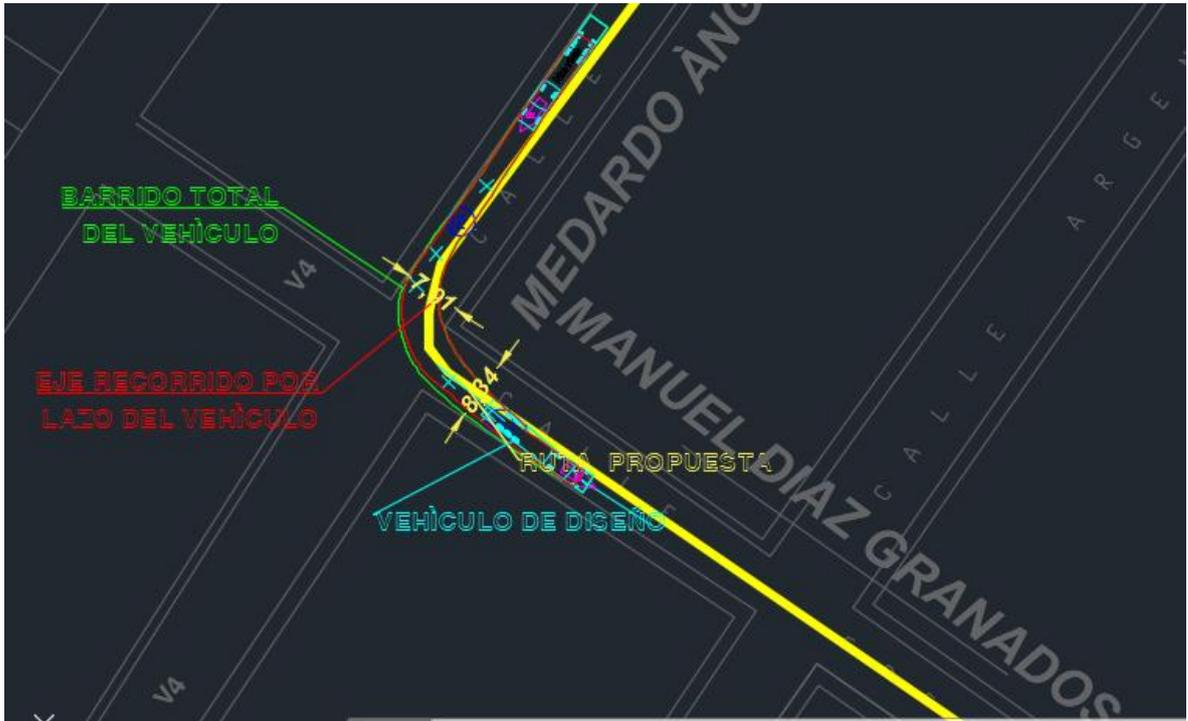
**Ilustración N°. 47: Simulación de barrido total de vehículo de diseño en la intersección M. Ángel Silva y Manuel Díaz Granado**
