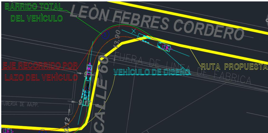
**Ilustración N°. 44: Simulación de barrido total de un vehículo tipo de carga pesada en la intersección comprendida entre la calle 60 y Av. León Febres Cordero**
