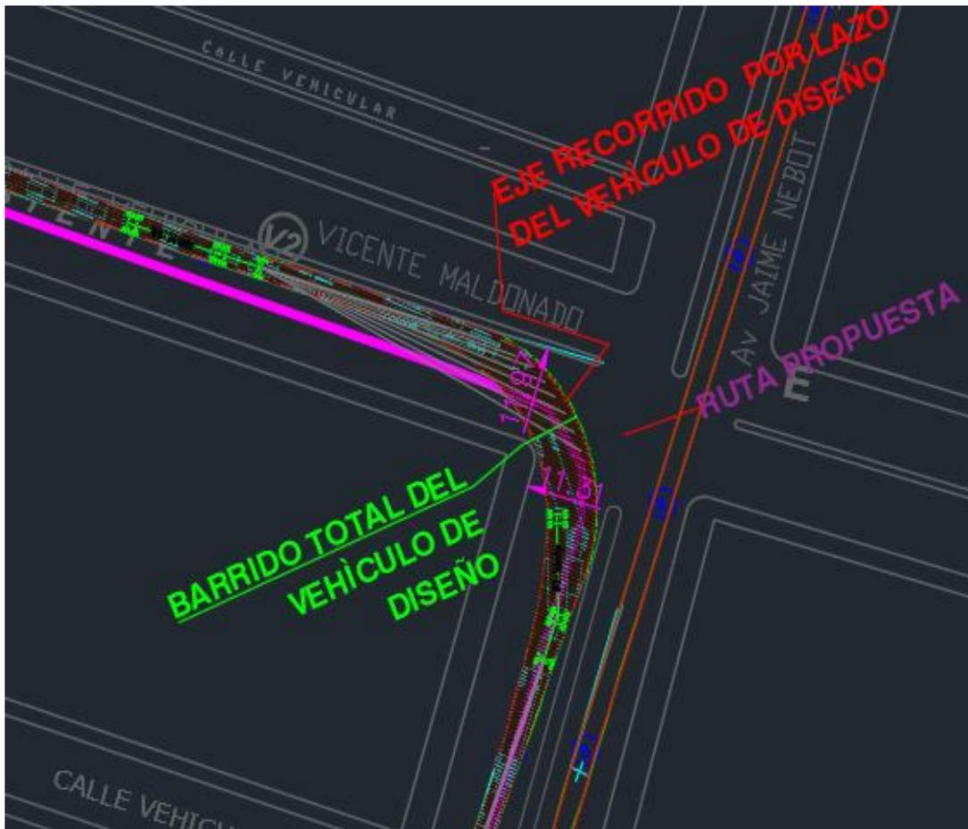
**Ilustración N°. 56: Simulación de barrido total de vehículo de diseño en la intersección comprendida entre la vía denominada como Pedro Vicente Maldonado y la Av. Jaime Nebot**
