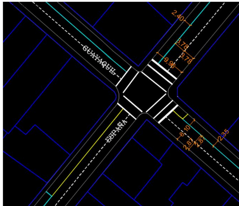
Ilustración 142: Propuesta de señalización horizontal, intersección 012
