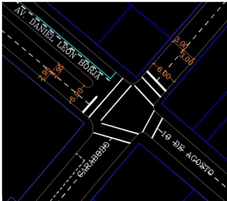
Ilustración 144: Propuesta de señalización horizontal, intersección 014
