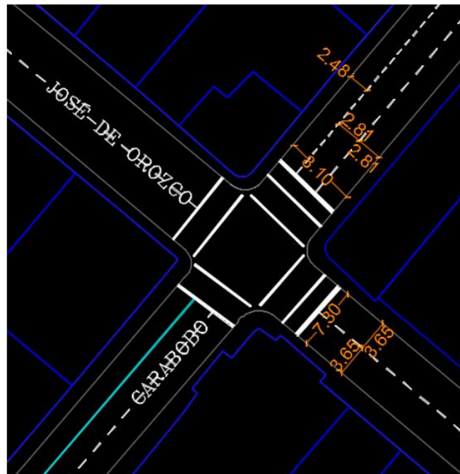
Ilustración 138: Propuesta de señalización horizontal, intersección 008
