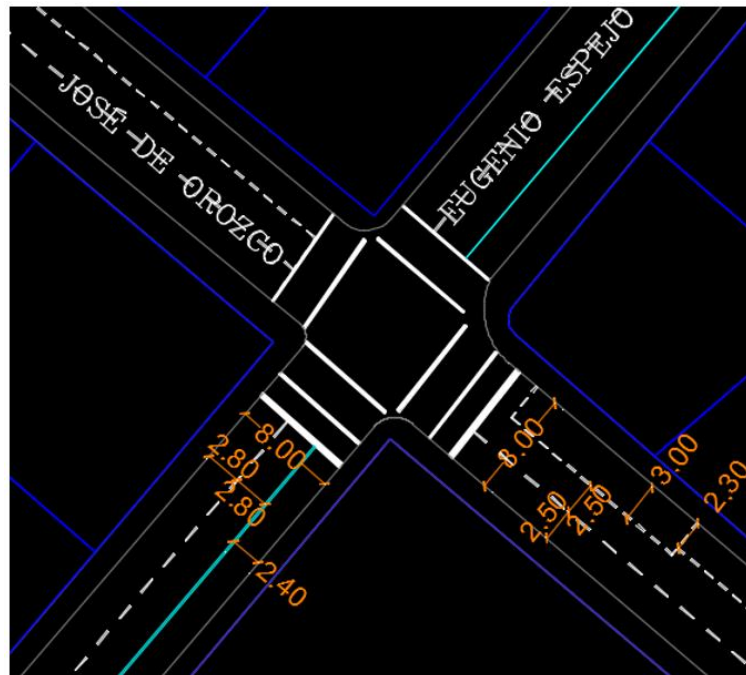
Ilustración 136: Propuesta de señalización horizontal, intersección 006
