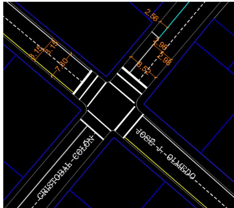
Ilustración 141: Propuesta de señalización horizontal, intersección 011
