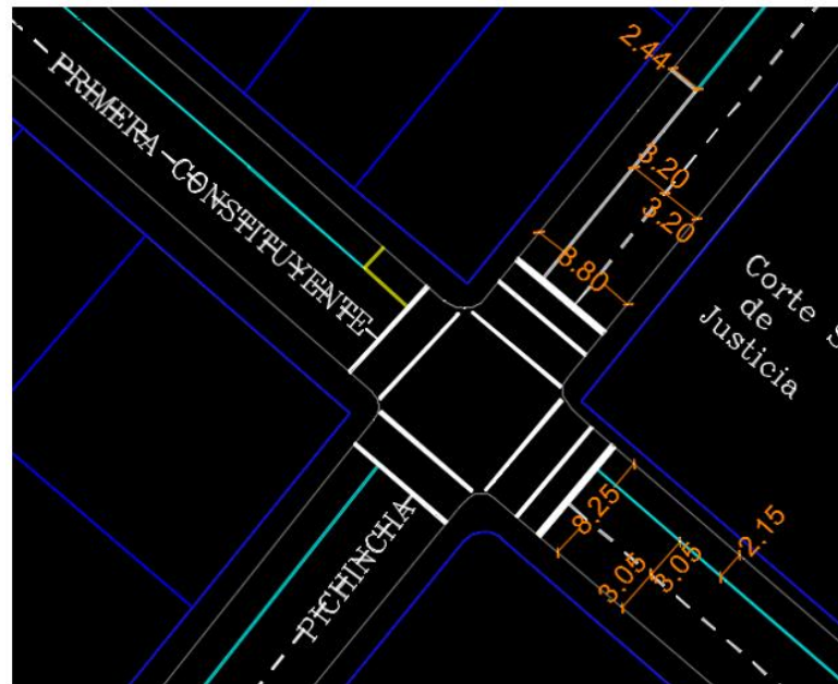
Ilustración 134: Propuesta de señalización horizontal, intersección 004.
