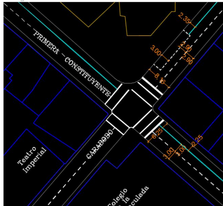
Ilustración 135: Propuesta de señalización horizontal, intersección 005
