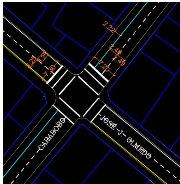
Ilustración 139: Propuesta de señalización horizontal, intersección 009
