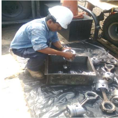
Figura 66. Falta de utilización de equipos de protección.
