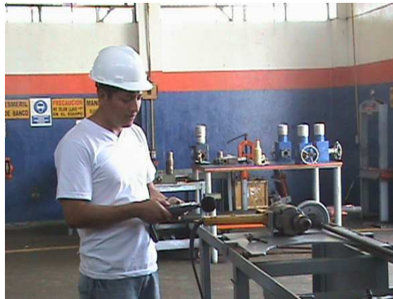
Figura 106. Toma de mediciones de ruido.
