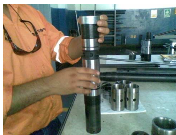
Figura 8. Armado de la bomba.
