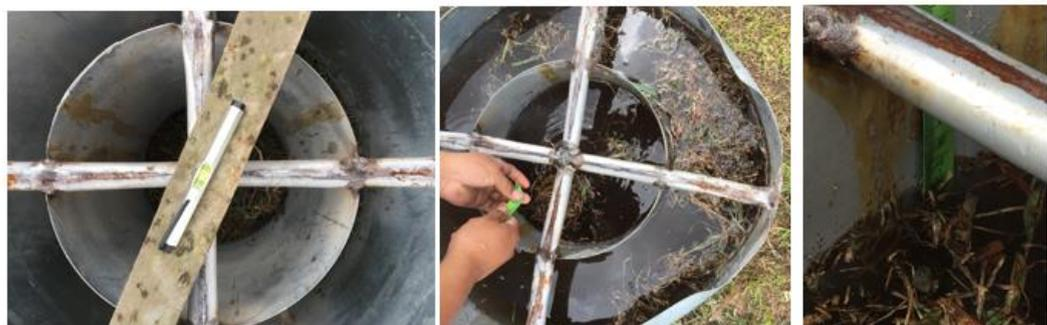
**Gráfico 3-3:** Prueba de infiltración por método del cilindro infiltrómetro.
