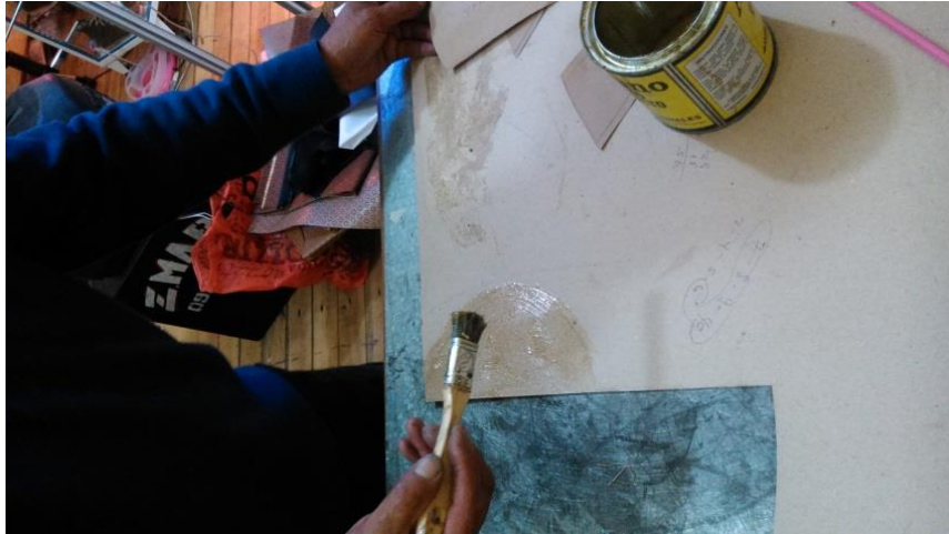
Gráfico N° 31: Unión de la parte externa e interna de la capellana con pegamento
