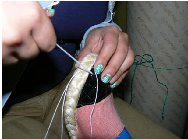
Gráfico N° 33: Cocida a mano de la capellana con la plantilla
